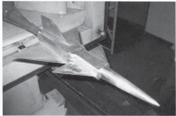
図10 小型超音速実験機モデルの風洞試験（室蘭工大）
